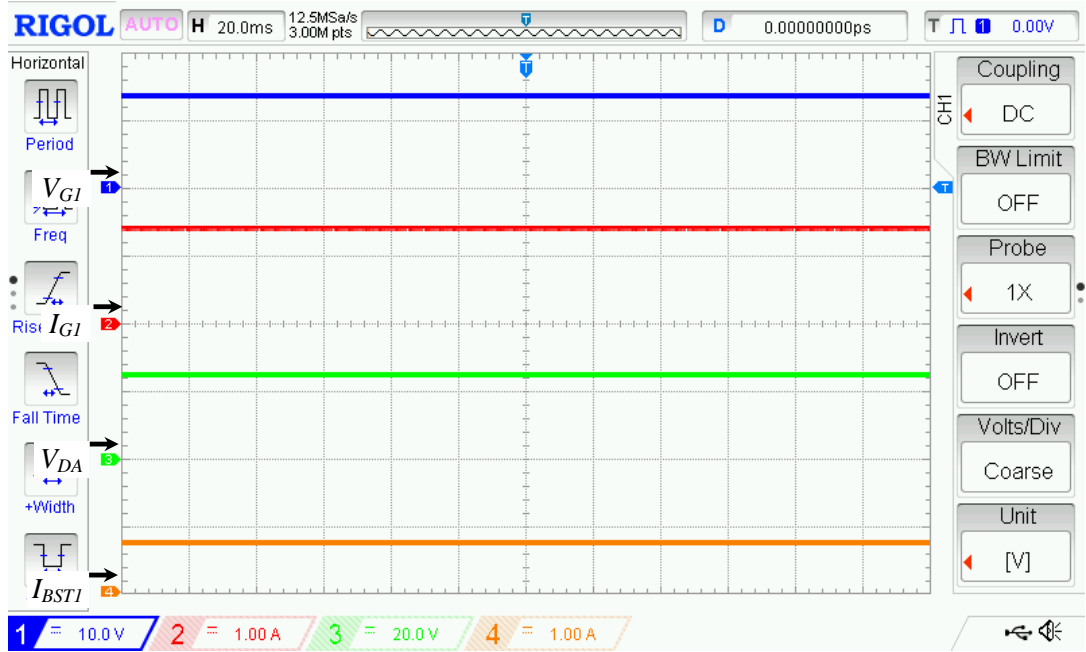
Şekil 5.11. Durum 3 için rüzgâr türbin generatör, DA/DA yükseltici çıkış gerilim ve akımları.
