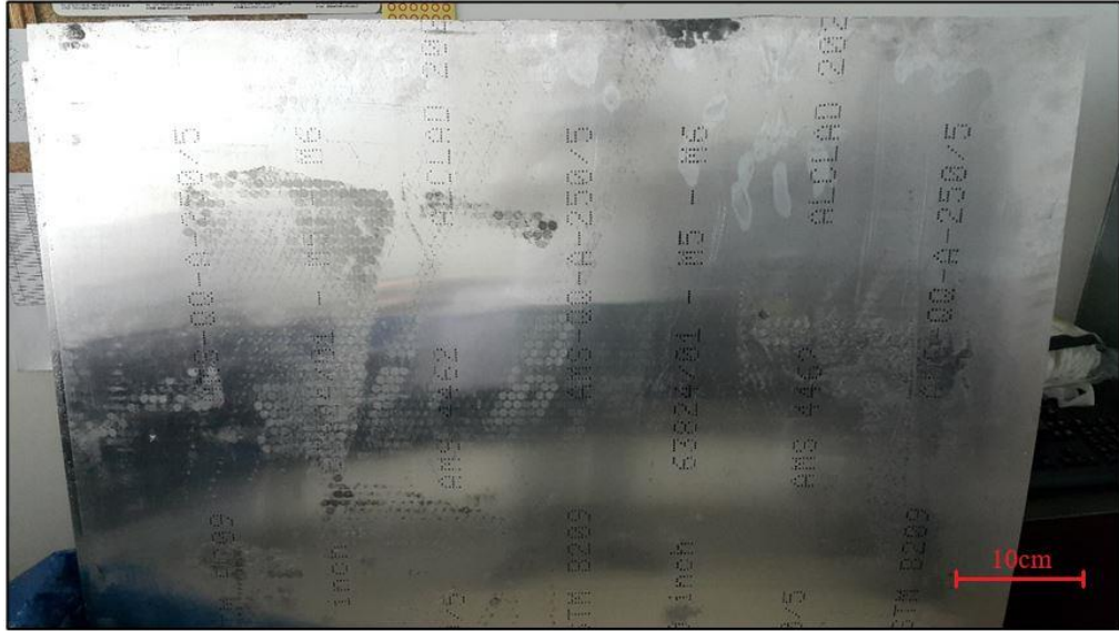
Şekil 5.1. FML üretiminde kullanılan 2024-T3 alüminyum levhanın görüntüsü.
