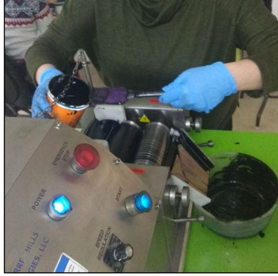
Şekil 5.19. Three roll mill cihazı ile epoksi reçineye nano takviye işlemleri.
