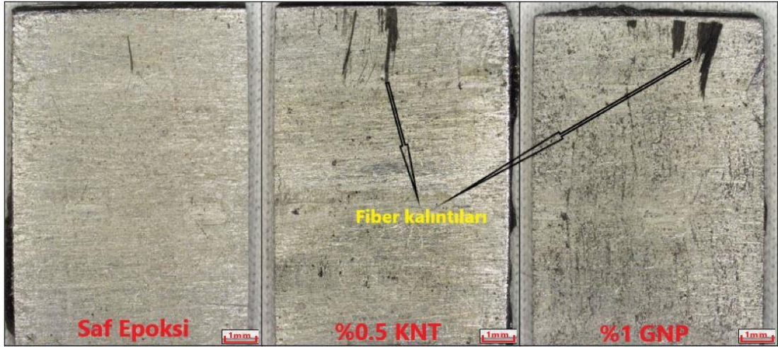
Şekil 6.14. Nanopartikül takviyeli FML' lerin delaminasyon sonrası metal tabakalarının arayüzey görüntüsü.
