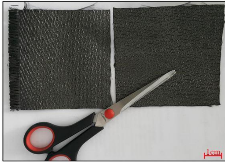
Şekil 5.12. Laminasyon işlemi için kesilen PEEK emprenyeli dokuma karbon fiber prepreg.
