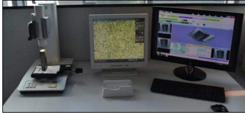
Şekil 5.26. NIKON Shuttle Pix portatif dijital stereo mikroskop.
