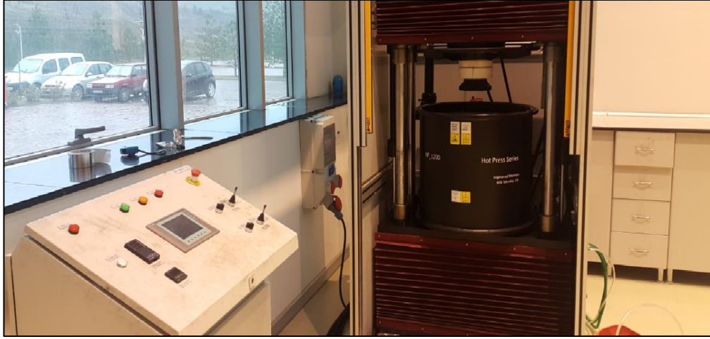
Şekil 5.17. FML' lerin üretildiği sıcak pres cihazı.
