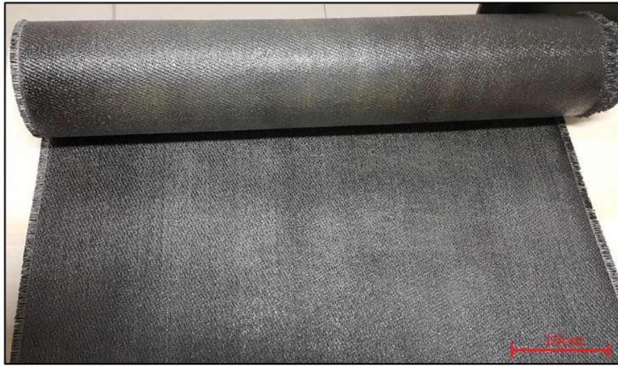
Şekil 5.8. PEEK emprenye edilmiş dokuma karbon fiber prepreg görüntüsü.
