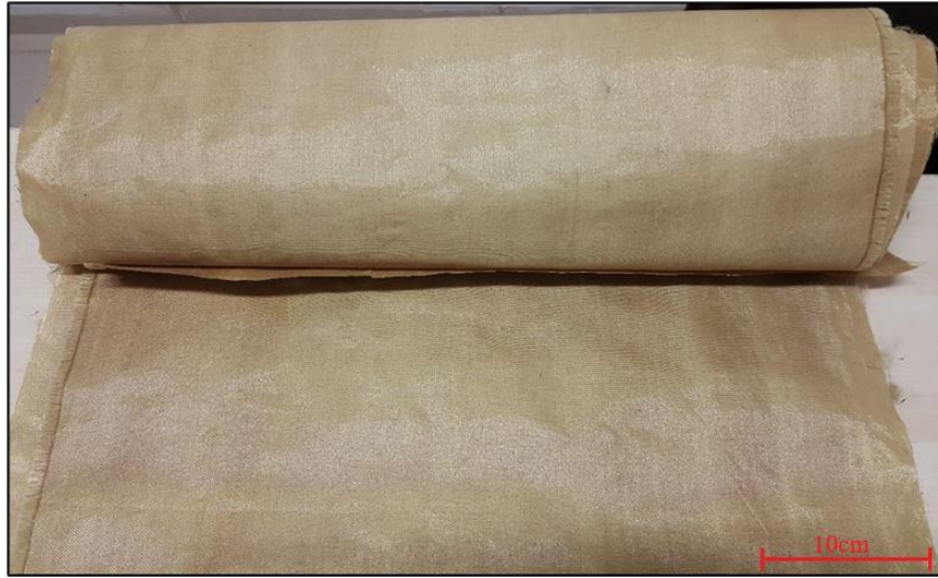
Şekil 5.9. PEEK emprenye edilmiş dokuma aramid fiber prepreg görüntüsü.
