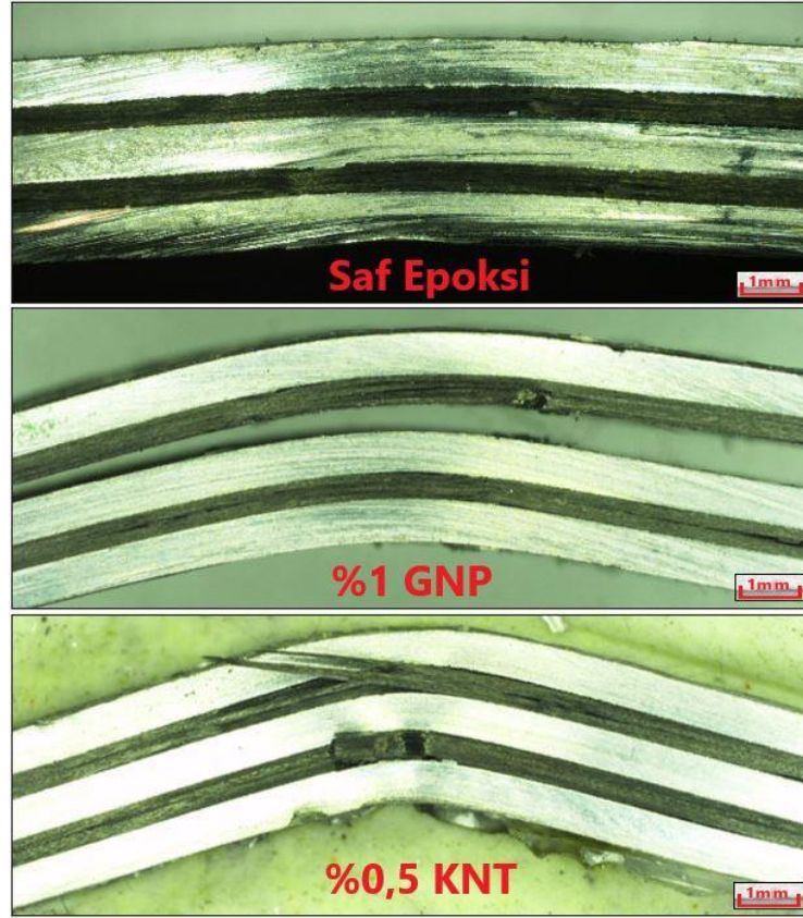
Şekil 6.82. Nanopartikül ilaveli epoksi reçineler ile üretilen FML' lerin eğme testi sonrası 20 X büyütmedeki arayüzey görüntüleri.
