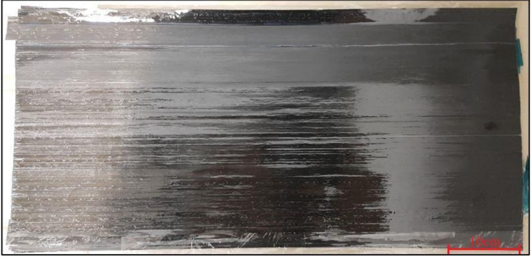
Şekil 5.7. PEEK emprenye edilmiş tek yönlü karbon fiber prepreg görüntüsü.
