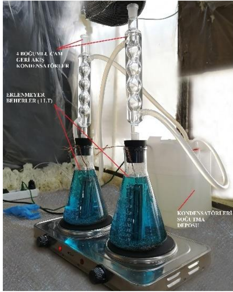
Şekil 5.2. Taneler arası asit deneyi yönteminin düzeneği.
