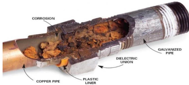
Şekil 4.2. Galvaniz kaplanmış su borularında bağlantılı farklı metaller olmalarından dolayı oluşan galvanik korozyona örnek.
