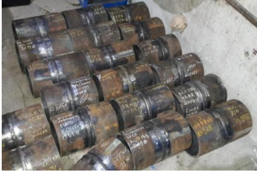
Şekil 2.12. AISI 1020 Kalite karbon çeliğinden TIG kaynaklı kaynakçı test boruları.
