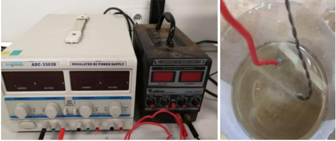
Şekil 5.8. Elektrolitik dağlama ve çözelti içindeki anot & katot uçları.
