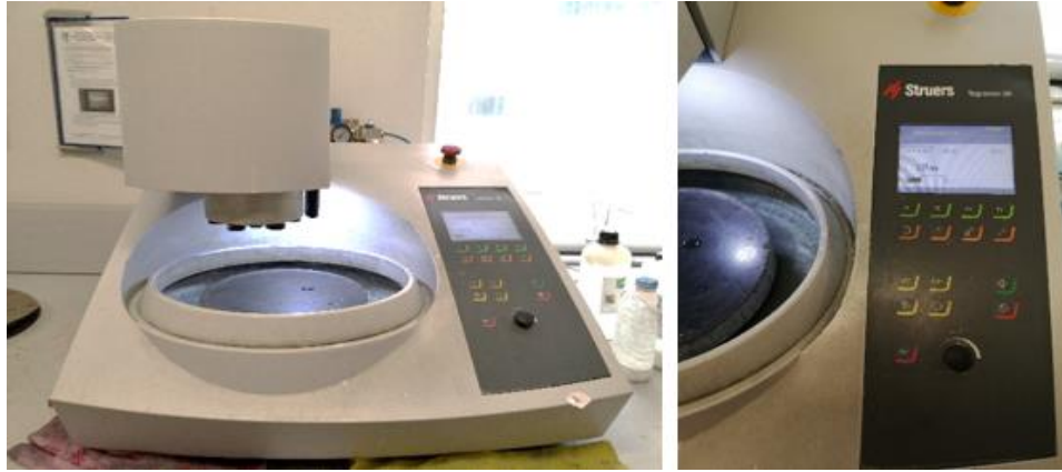
Şekil 5.7. Struers Tegramin-30 otomatik zımparalama ve parlatma cihazı.
