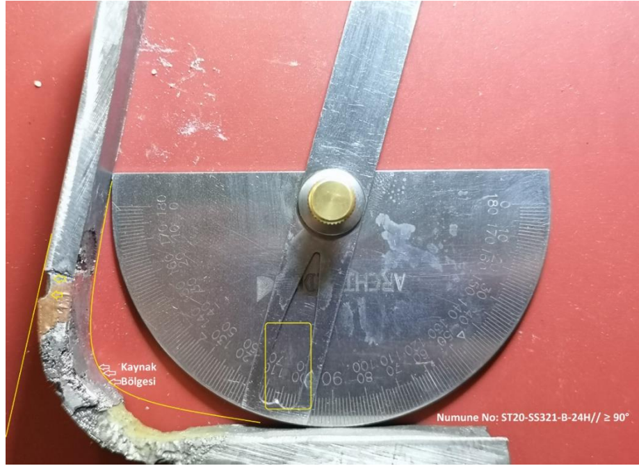
Şekil 6.22. AISI 321/St20 Kalite kaynaklı test numunesinin 8 saat asit test çözeltisinde bekleddikten sonra uygulanan 90° bükme test numunesi.
