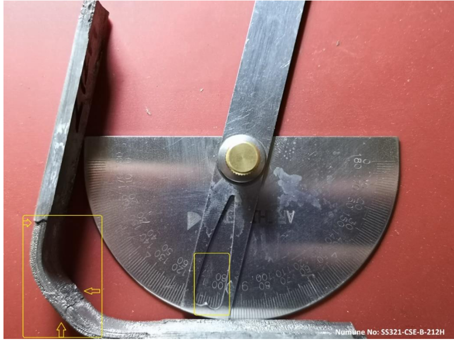
Şekil 6.20. AISI 321 Kalite kaynaklı test numunesinin karbon çeliği eklenerek hassaslaştırılmış çözelti ortamında 212 saat bekleddikten sonra uygulanan 90° bükme test numunesi.
