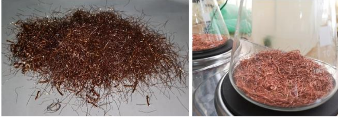
Şekil 5.4. Çözelti etkileşimini arttırmak için erlenmeyer beherin tabanını kaplayacak şekilde serilen metalik bakır.
