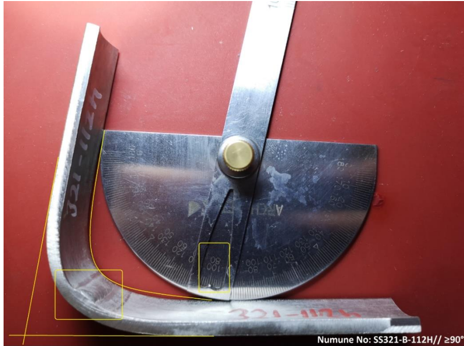
Şekil 6.18. AISI 321 Kalite kaynaklı test numunesinin 122 saat çözeltide bekledikten sonra uygulanan 90° bükme test numunesi.
