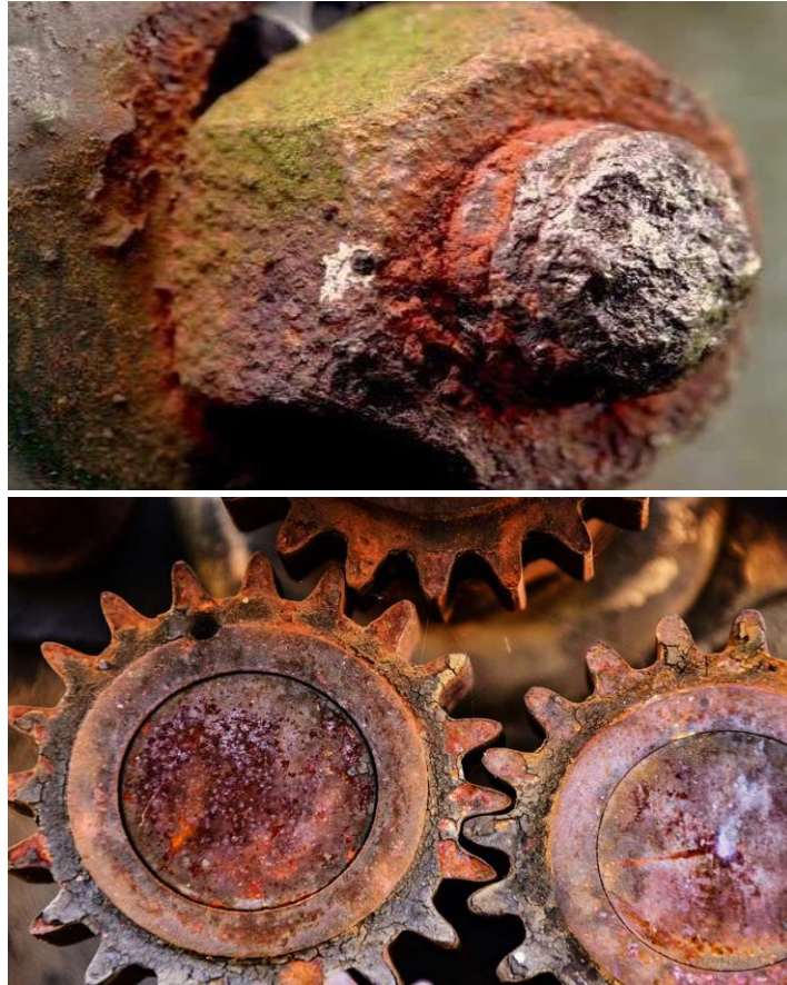
Şekil 4.1. Üniform korozyona örnek görseller.
