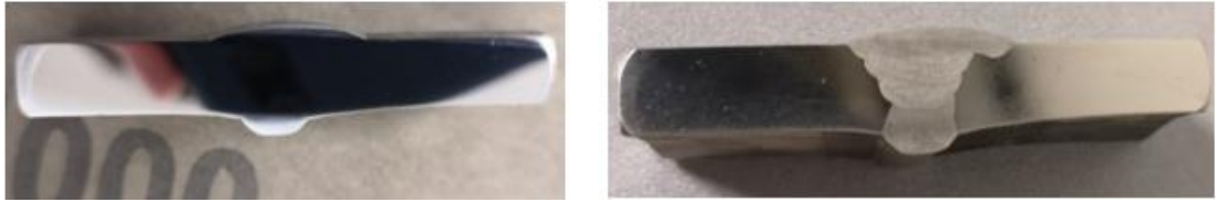
Şekil 5.9. %10 Oksalik asit çözeltisi içerisinde elektrolitik olarak 8.5V ve 60 sn dağlanan kaynaklı numuneler.
