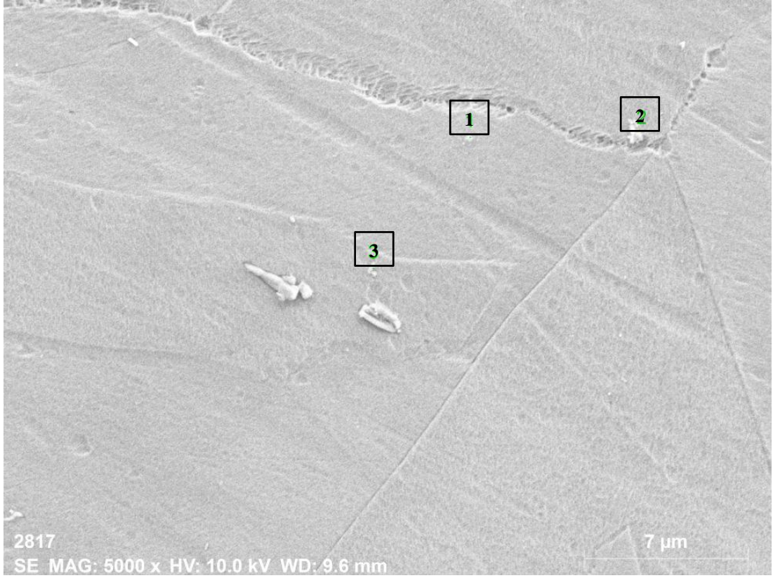
Şekil 6.24. Kaynaklı AISI 316 kalite östenitik paslanmaz çelik numunedan alınan SEM görüntüsü.
