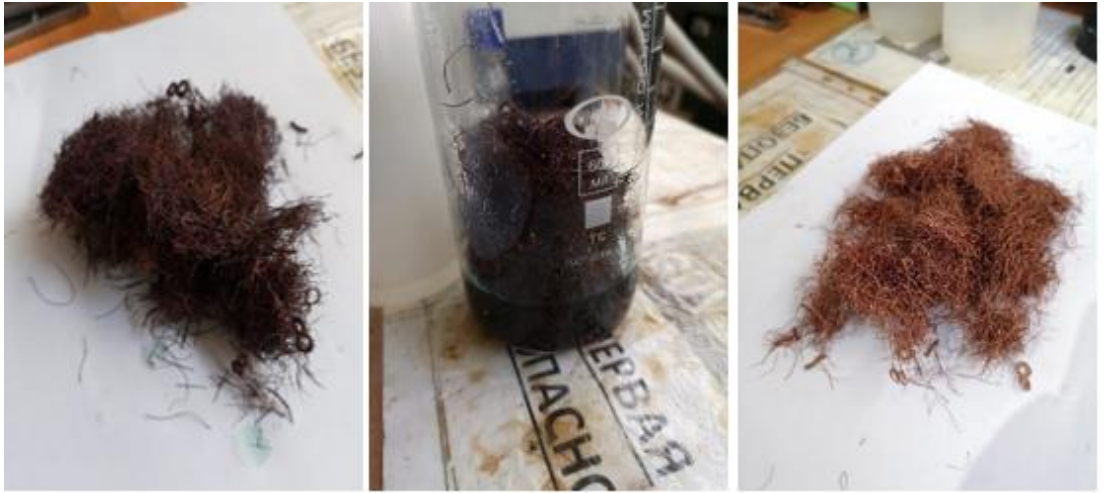
Şekil 5.6. Kararmış bakır talaşının nitrik asit çözeltisi içinde bekletilerek yeniden kullanılabilir hale getirilmesi.
