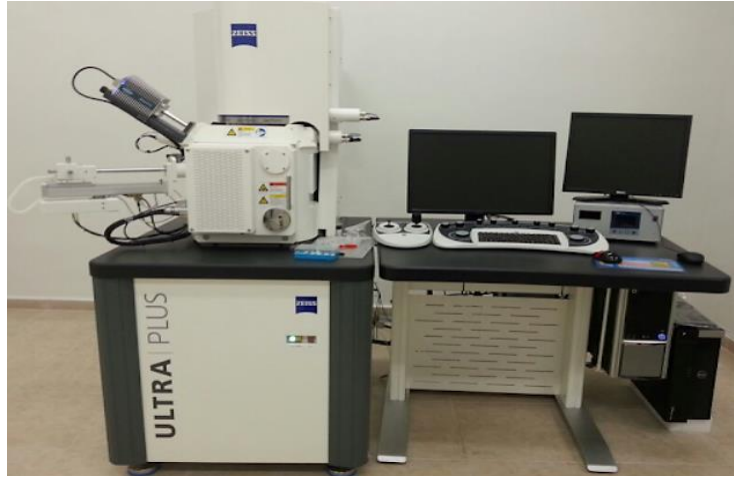
Şekil 5.11. Carl Zeiss Ultra Plus Gemini Fesem.
