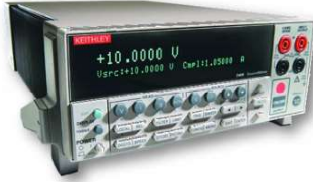
Şekil 3.16. SD 1 ve SD 2 numunelerinin I-V ölçümlerinde kullanılan kaynağı Keithley 2400 akım-gerilim kaynağının fotoğrafı.
