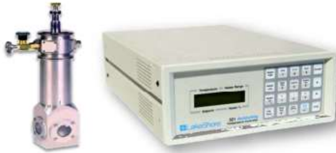
Şekil 3.17. SD 1 ve SD 2 numunelerinin 80- 360 K sıcaklık aralığında alınan I-V ölçümlerinde kullanılan Janis vpf-475 kriyostat ve Lake Shore Model 321 sıcaklık kontrol sistemlerinin fotoğrafı.
