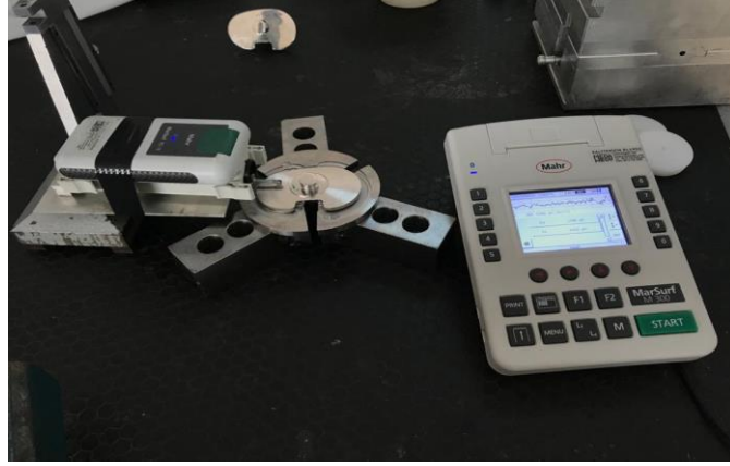
Şekil 6.8. Yüzey pürüzlülük ölçüm düzeneği.
