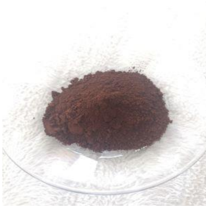
Şekil 4.8. Fren balatlarında aşındırıcı olarak kullanılan demir III oksit.
