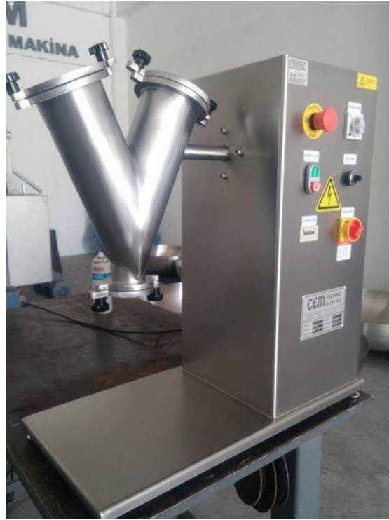
Şekil 4.11. Balata numunelerindeki tozların karıştırılmasında kullanılan turbulent tipi mekanik karıştırıcı.
