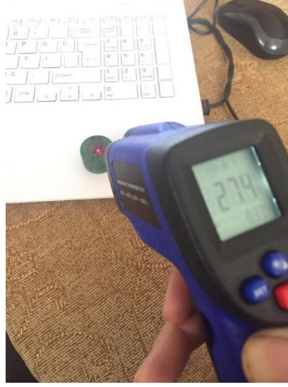
Şekil 4.4. Balata yüzey sıcaklığını ölçmek için kullanılan lazer termometre.
