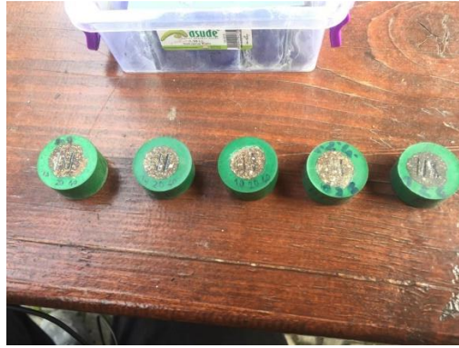
Şekil 4.14. Testlerin daha sağlıklı yapılması amacıyla bakalit gömme yapılmış balata numuneleri.
