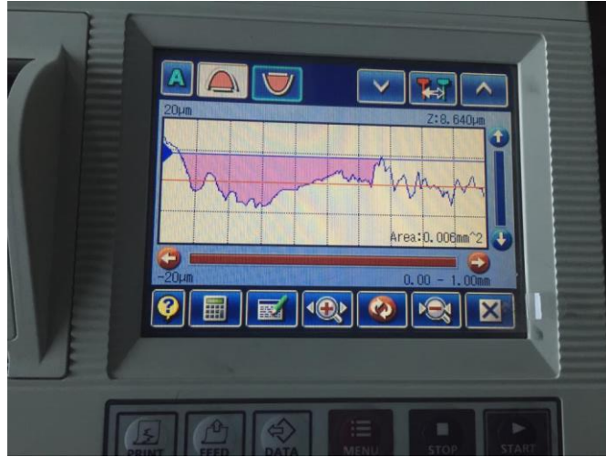
Şekil 5.40. Yüzeyi yeterince pürüzlü olan numunelerde birincil ve ikincil pürüzlülük seviyelerinin ölçülmesi.
