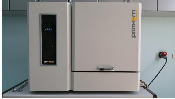
Şekil 4.2. Fren balatalarının ısıl işlem prosesinde kullanılan fırın.
