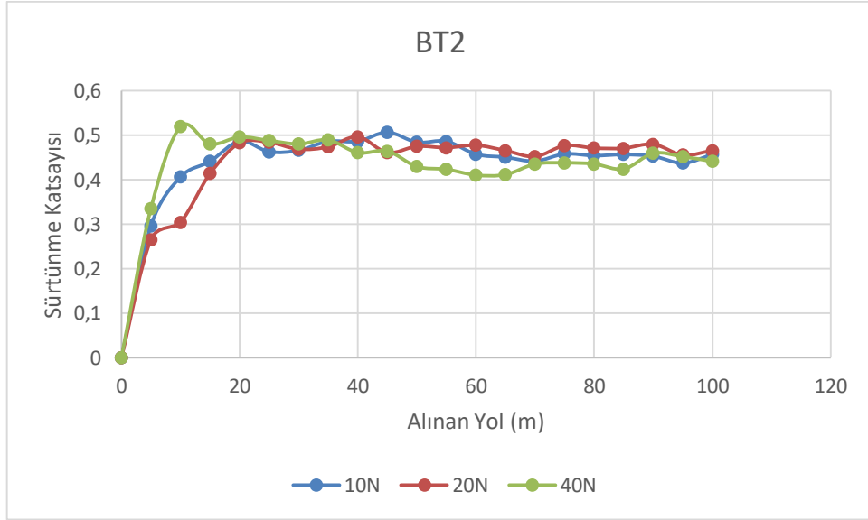
Şekil 5.20. BT2 kodlu numunenin farklı yükler altında sürtünme katsayısının değişimi.
