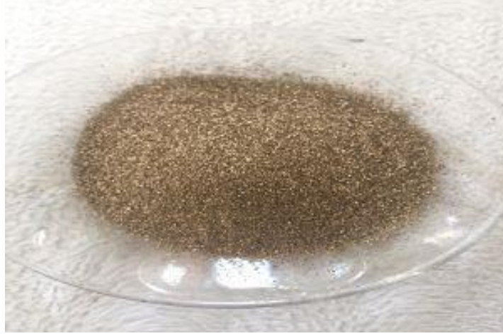
Şekil 4.6. Fren balatalarında yapısal malzeme olarak kullanılan bronz talaşı.
