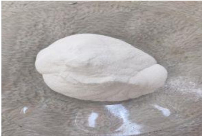
Şekil 4.9. Fren balatlarında aşındırıcı olarak kullanılan alüminyum oksit.
