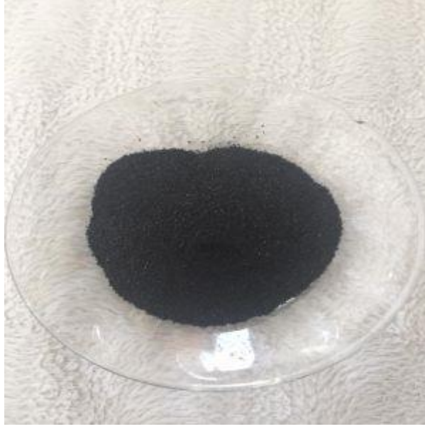
Şekil 4.10. Fren balataalarında yağlayıcı olarak kullanılan grafit tozu.
