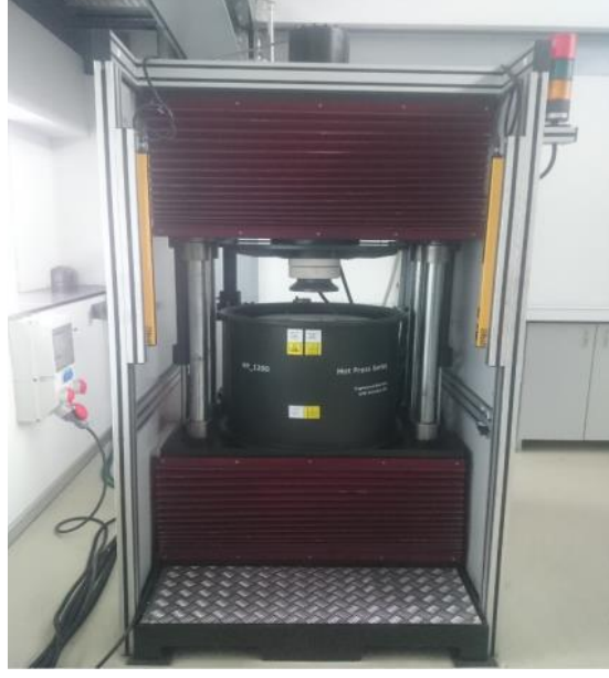
Şekil 4.1. Fren balatası üretiminde kullanılan sıcak pres sistemi
