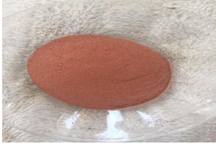
Şekil 4.7.. Fren balatlarında yapısal malzeme olarak kullanılan bakır tozu.
