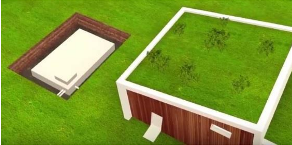
Şekil 2.34. Gaziantep Ekolojik Bina yeşil çatı uygulaması ve yağmur suyu toplama arıtma deposu [62].
