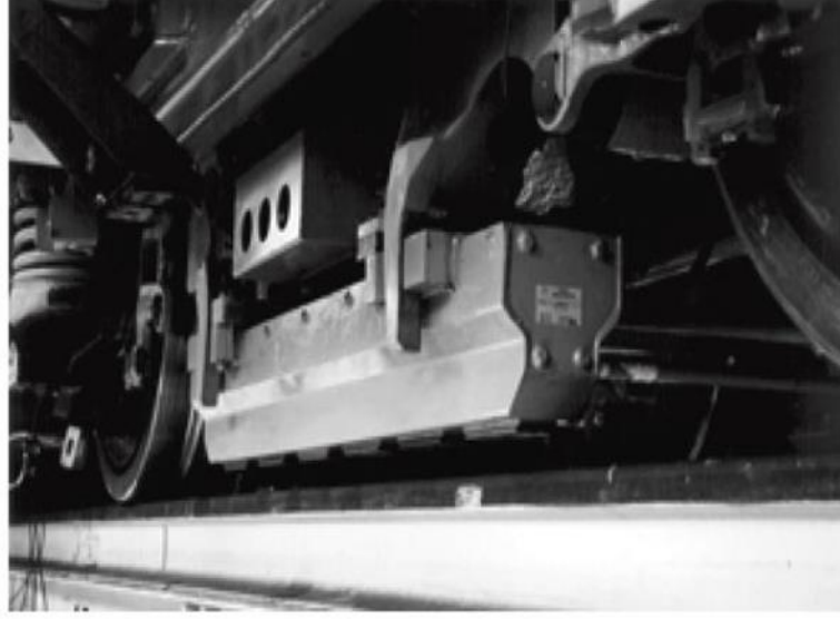
Şekil 2.10. Elektromanyetik frenin yandan görünüşü.
