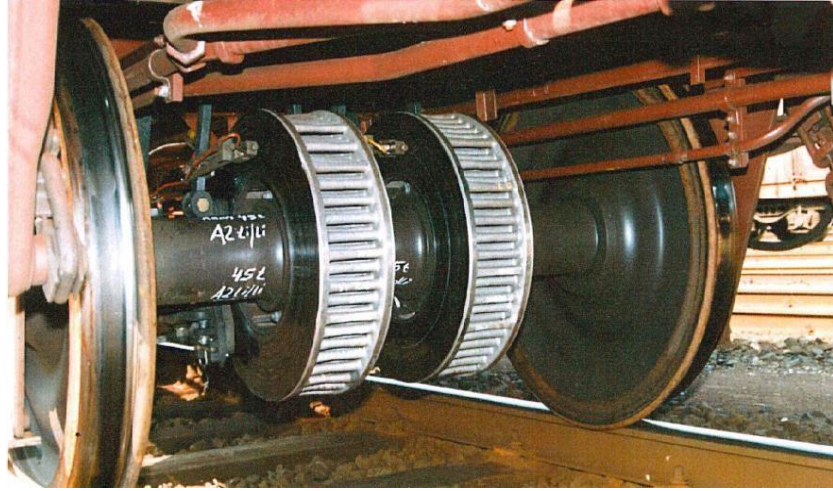
Şekil 2.8. Aks göbeğine bağlı bir disk fren örneği.
