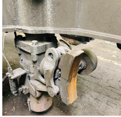
Şekil 2.11. Kardemir’de bulunan DE10000 Tülomsaş lokomotiflerinde kullanılan kompozit sabo.
