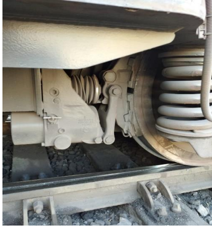
Şekil 2.11. Kardemir’de bulunan DE10000 Tülomsaş lokomotiflerinde kullanılan kompozit sabo.
