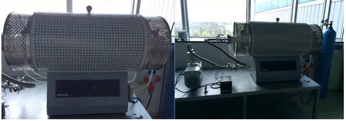
Şekil 6.2. Deneysel çalışmalarda kullanılan atmosfer kontrollü ısıtma işlem fırını.
