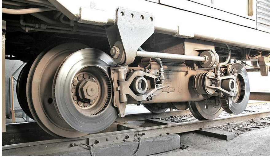
Şekil 2.7. Tokyo 7000 serisi EMU tipi aracın bojisindeki disk frenler.
