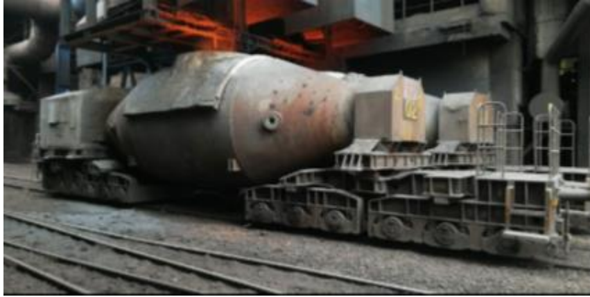
Şekil 2.3. Yüksek fırından döküm alan bir torpedo.
