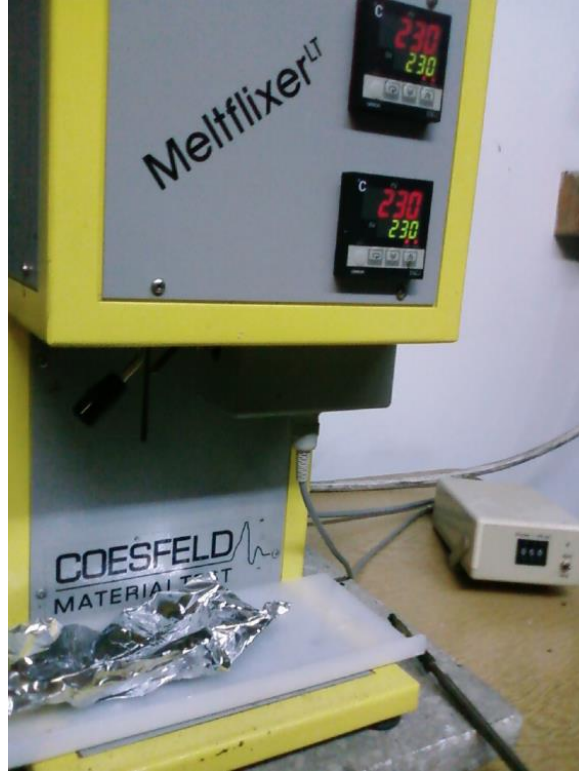
Şekil 3.9. Erime akış indeksi cihazı [11].
