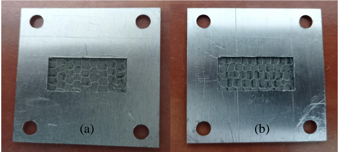
Şekil 3.47. Bakır boya üzerine bakır tozu ilaveli MMA'nın önden görünüm, TE polarizasyon (a) ve TM polarizasyon (b).
