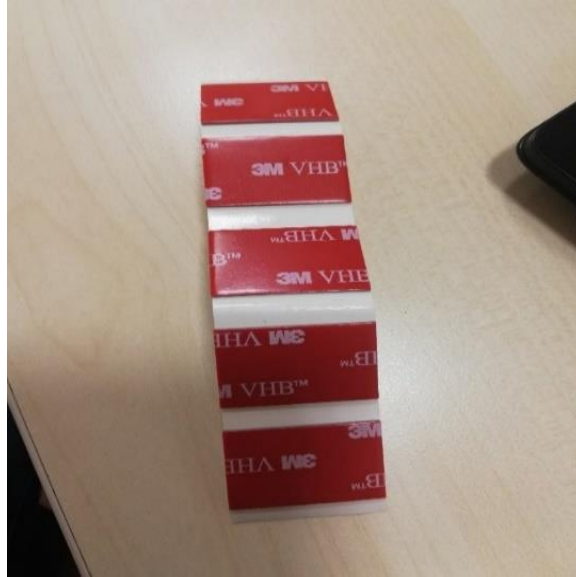
Şekil 3.16. 1.1 mm kalınlık ve 30 x 20 mm boyutunda silikon esaslı çift taraflı bant.
