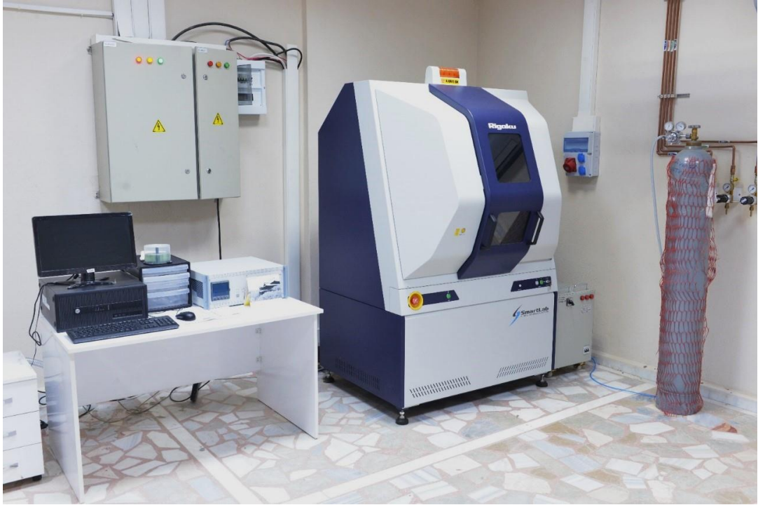
Şekil 5.9. Rigaku SmartLab X-ışını kırınım cihazı
