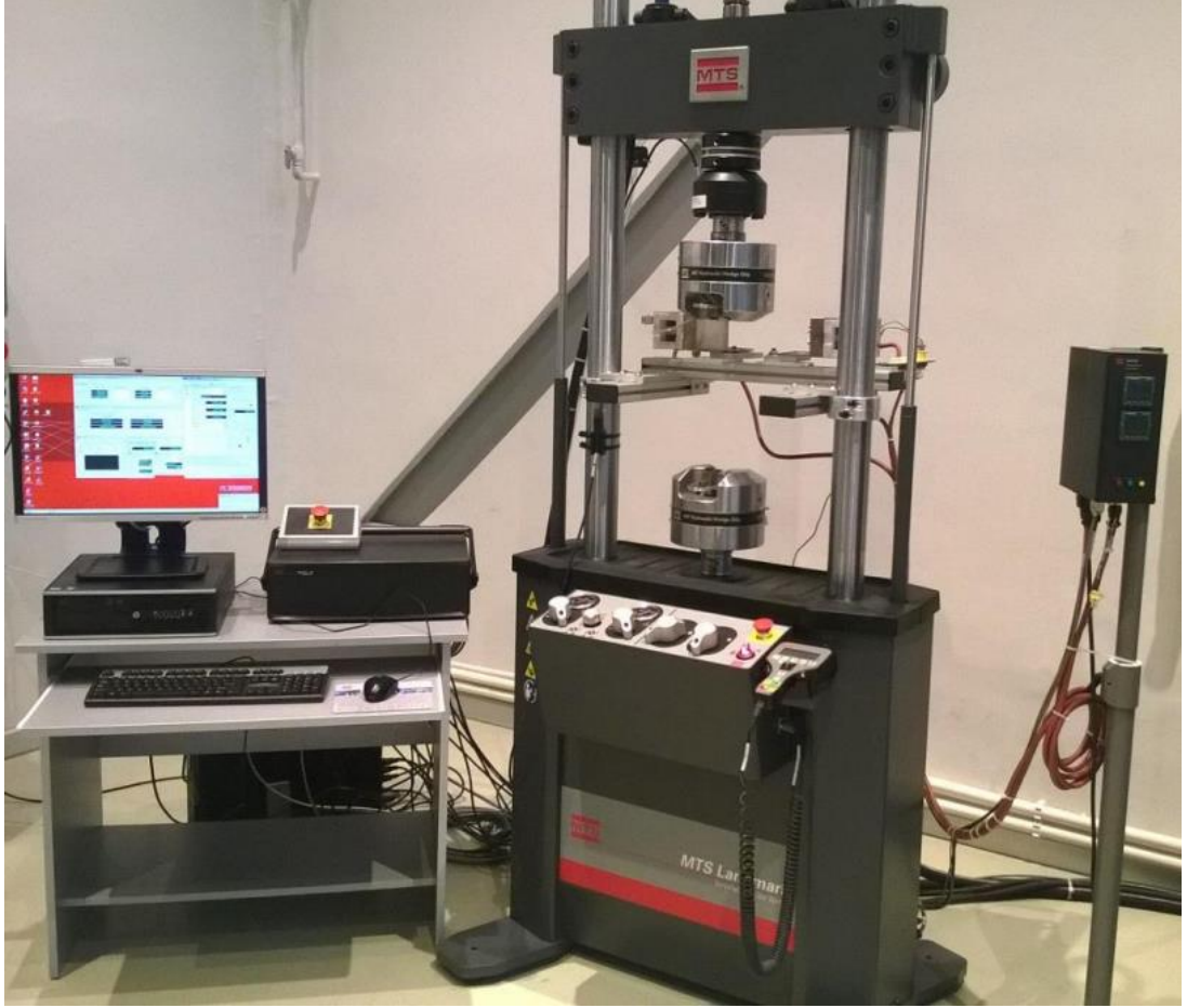
Şekil 5.12. MTS 100 kN Servohidrolik Dinamik Test Cihazı
