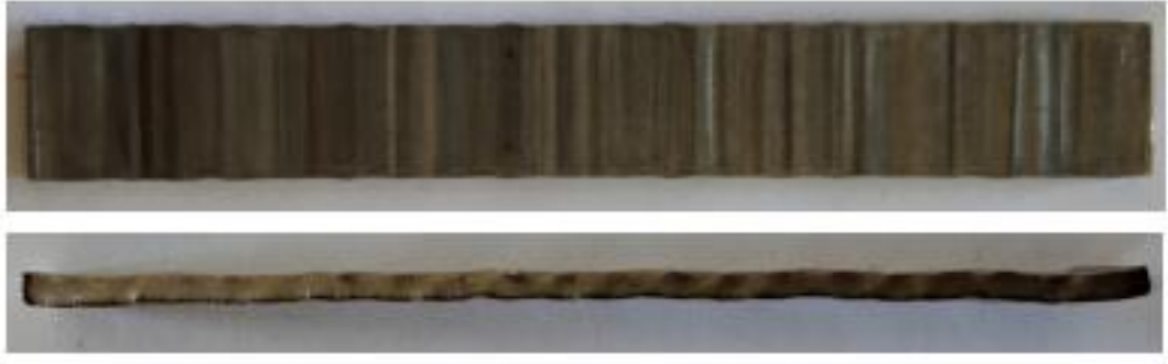
Şekil 5.4. Dört paso SYP uygulanmış numunenin yüzey (üstte) ve kesit (altta) görüntüleri.
