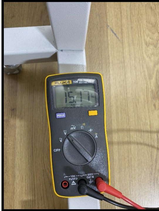
Şekil 4.10. İnce film panel %80 kapalı durumda çıkış voltajı.
