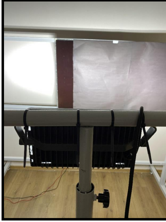
Şekil 4.9. İnce film panel %80 oranında ışık almıyor durumda.
