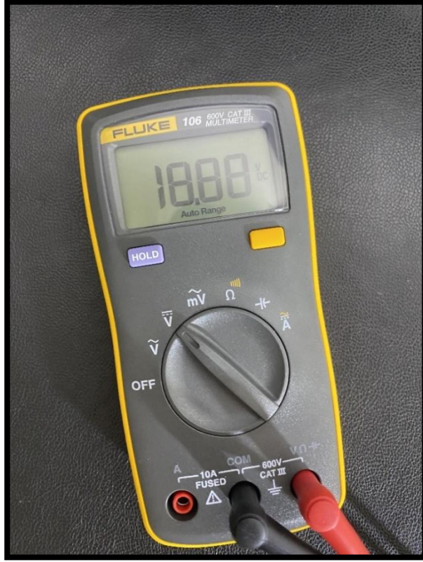
Şekil 4.2. Monokristal panel maksimum çıkış voltajı.
