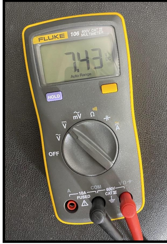
Şekil 4.12. Esnek panel %62,5 oranında gölge durumunda çıkış voltaj değeri.
