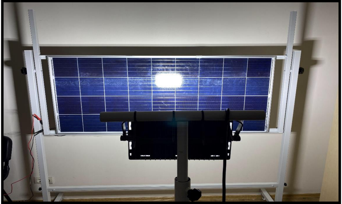
Şekil 4.5. Polikristal panel gölgesiz ölçüm aşaması.
