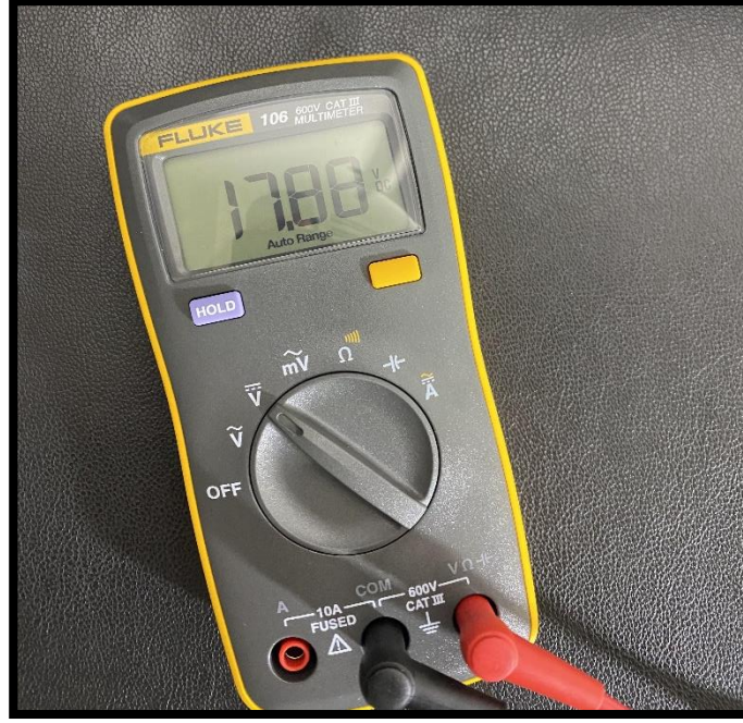
Şekil 4.6. Polikristal panel maksimum çıkış voltajı.
