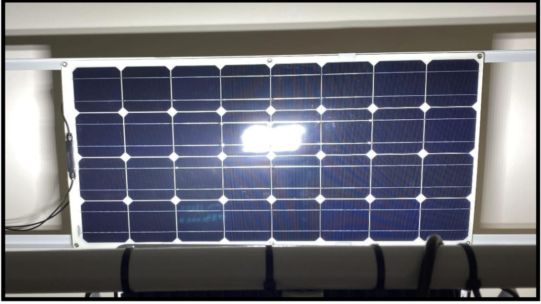
Şekil 3.4. Çalışmada kullanılan esnek panel.
